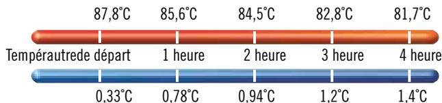
**Froid** — Gain de température de 0,4°C/heure en moyenne.
