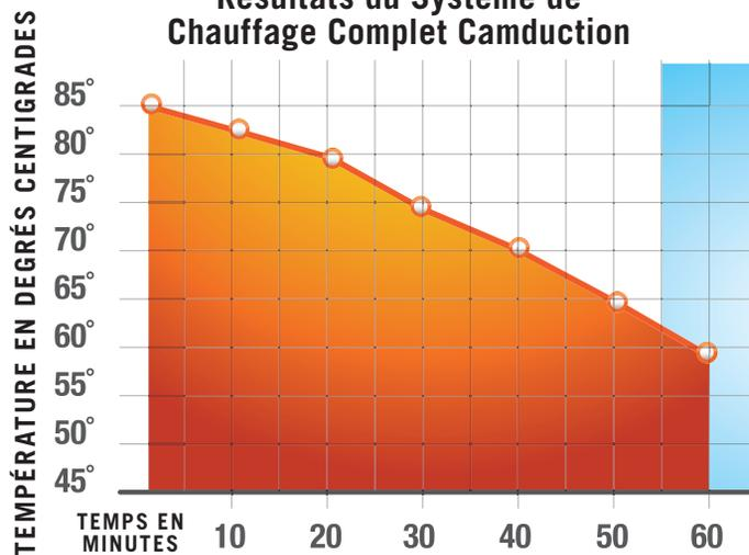
Pour une conservation thermique optimale, réchauffez l'assiette à +90°-100°C avant d'y placer les aliments chauffés à 85°C.
